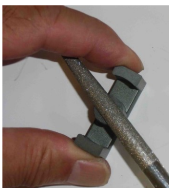
写真4 トランスのインダクタンス調整
